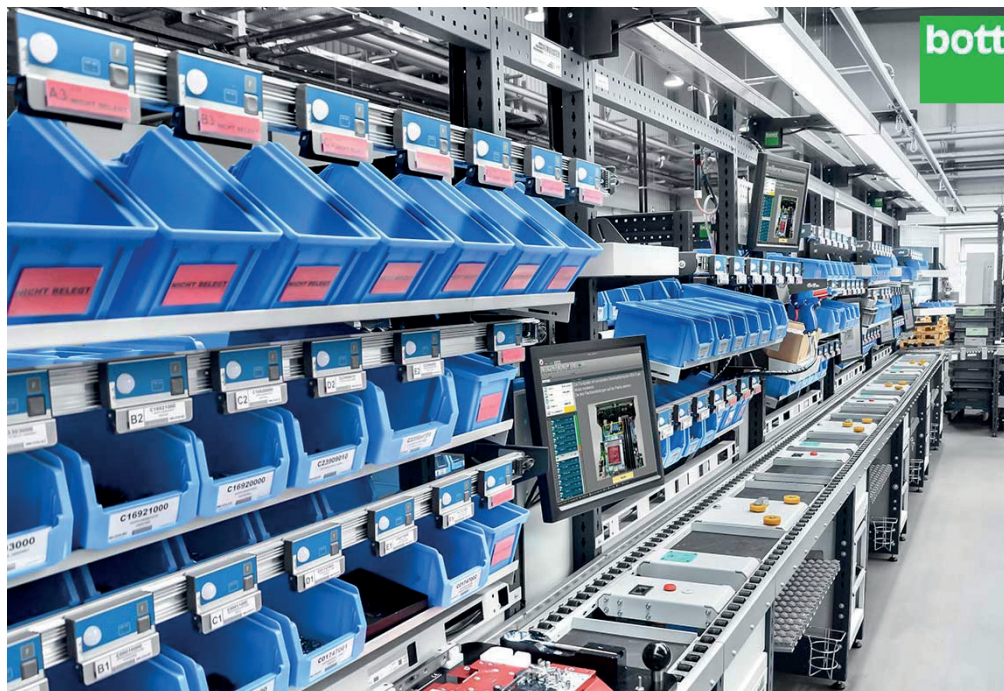
Abbildung 2: Mit steigendem Individualisierungsgrad wächst das Risiko von Montagefehlern. Kleinteile-Lagersysteme sollten über eine klare Beschriftung, eine übersichtliche Struktur sowie ergonomisch bereitgestellte Behälter verfügen. Mittels „Pick-by-Light“ gelingt die intuitive, schnelle und sichere Montage.
